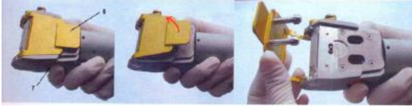
Resim 13: Bıçak bölmesinin açılması
